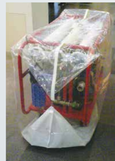
▲浄水機防水(水害対策に)
